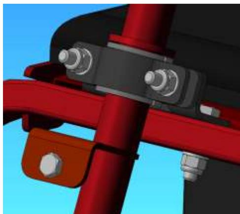
**Рис. 2** Установка стойки (верх).
