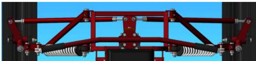
**Рис. 4** Установка стоек, тяг, лыж.
