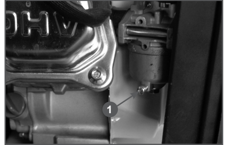
Рис. 24 Обслуживание фильтра-отстойника PC5332F
