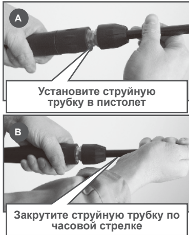
Рис. 5 Установка струйной трубки на пистолет
