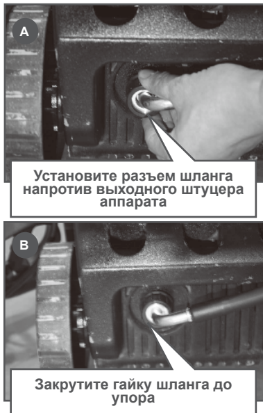
Рис. 4 Подключение шланга высокого давления к аппарату
